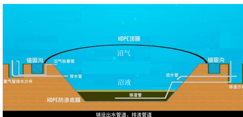
图 3.6-5 黑膜沼气池结构示意图
